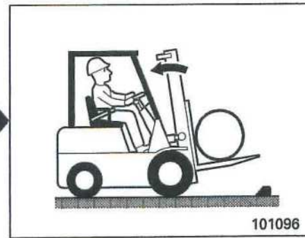
3. Incline el mástil totalmente hacia atrás para mantener la carga en las horquillas.
