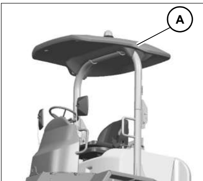
Fig.:64 Tejadillo de protección solar
