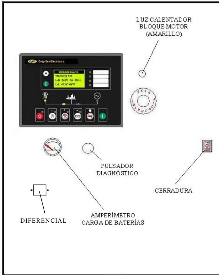
Imagen 8 - Cuadro de Control de Placa de Control DeepSea
