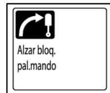
Si el bloqueo de las palancas de mando no está alzado, aparece el mensaje como mostrado en la ilustración derecha.
