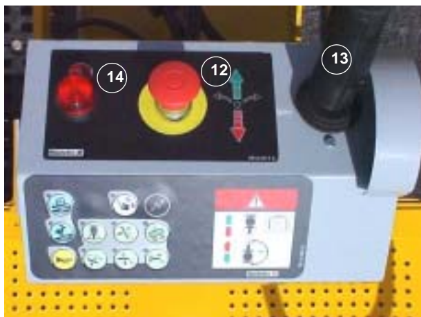
Foto 5: Puesto de mando barquilla
